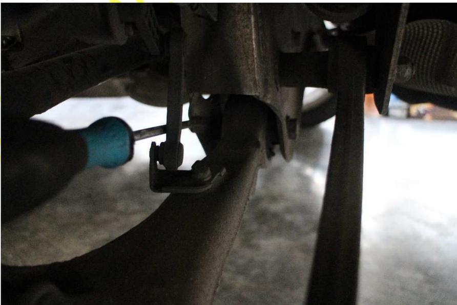
3. Hebeln Sie die Koppelstange oben am Sensor vorsichtig ab. Fixieren Sie den Sensorarm z.B. mit einer Kombizange (siehe Pfeil). Reinigen Sie die Kugelköpfe ggf. und schmieren diese mit etwas Fett:
