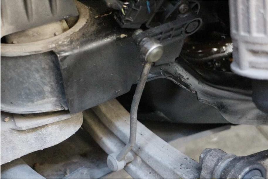
2. Hebeln Sie die Koppelstange – beginnend am Querlenker – mit einem geeigneten Schraubenzieher ab (sitzen fest):
