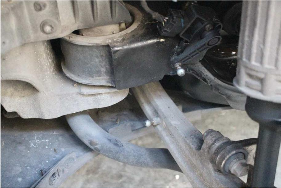
4. Montieren Sie die mitgelieferten Staubschutzkappen auf den Kugeln sowohl am Sensor als auch am Querlenker:
