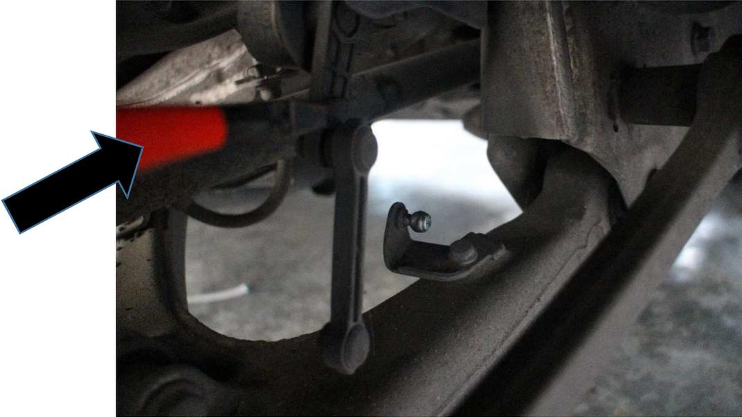
4. Montieren Sie die mitgelieferten Staubschutzkappen auf den Kugeln sowohl am Sensor als auch am Querlenker:
