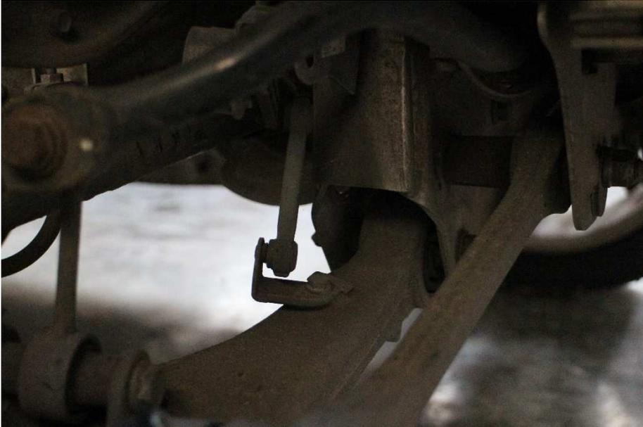
2. **ACHTUNG FEHLERQUELLE:** Merken Sie sich die Orientierung des Sensorhebels. Dieser muss zum Fahrzeuginneren zeigen! Hebeln Sie die Koppelstange – beginnend am Querlenker – mit einem geeigneten Schraubenzieher ab (sitzen fest):
