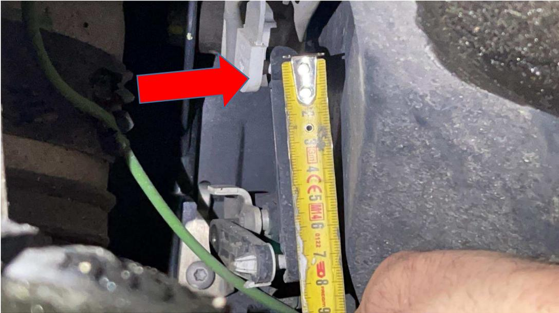
4. Montieren der neuen einstellbaren Koppelstangen (**die Version 2 hat für mehr Tieferlegung nur noch eine Mutter**). Diese werden aufgeclipst (viel leichter als die Originalen Koppelstangen). **Wichtig:** Anschließend werden die Sicherungsnasen (siehe Pfeile) oben und unten durch drücken eingerastet. Somit sind die Koppelstangen gesichert und können sich nicht lösen:
