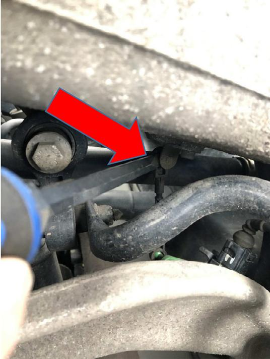
4. Montieren der neuen einstellbaren Koppelstangen. Diese werden aufgeclipst (viel leichter als die Originalen Koppelstangen). **Wichtig:** Anschließend werden die Sicherungsnasen (siehe Pfeile) oben und unten durch drücken eingerastet. Somit sind die Koppelstangen gesichert und können sich nicht lösen:
