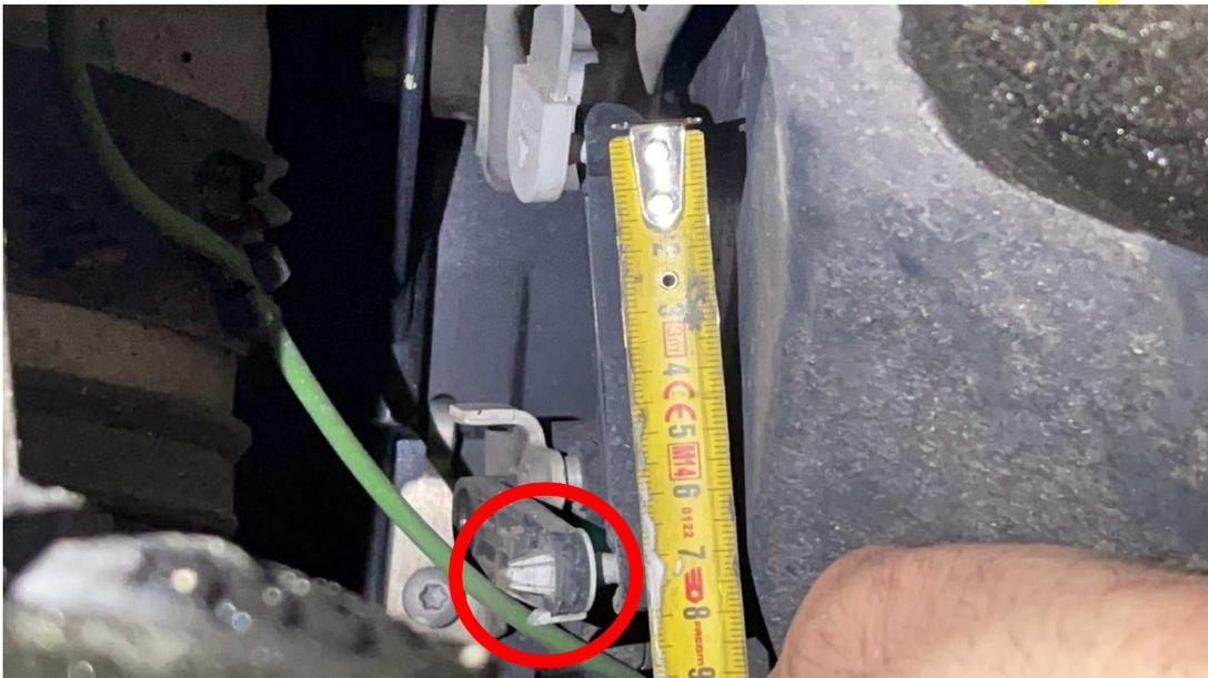
3. Hebeln Sie die Koppelstange oben an der Halterung ab. Verwenden Sie z.B. einen flachen Schraubendreher. Reinigen Sie die Kugelköpfe gegebenenfalls:
