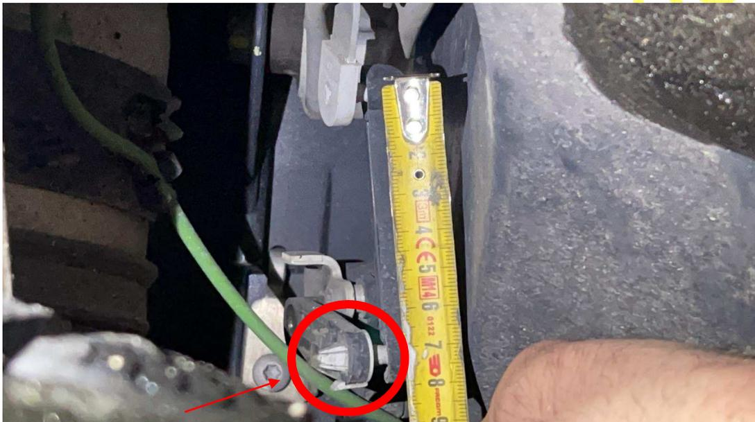
3. Hebeln Sie die Koppelstange oben an der Halterung ab. Verwenden Sie z.B. einen flachen Schraubendreher. Reinigen Sie die Kugelhöfe gegebenenfalls:
