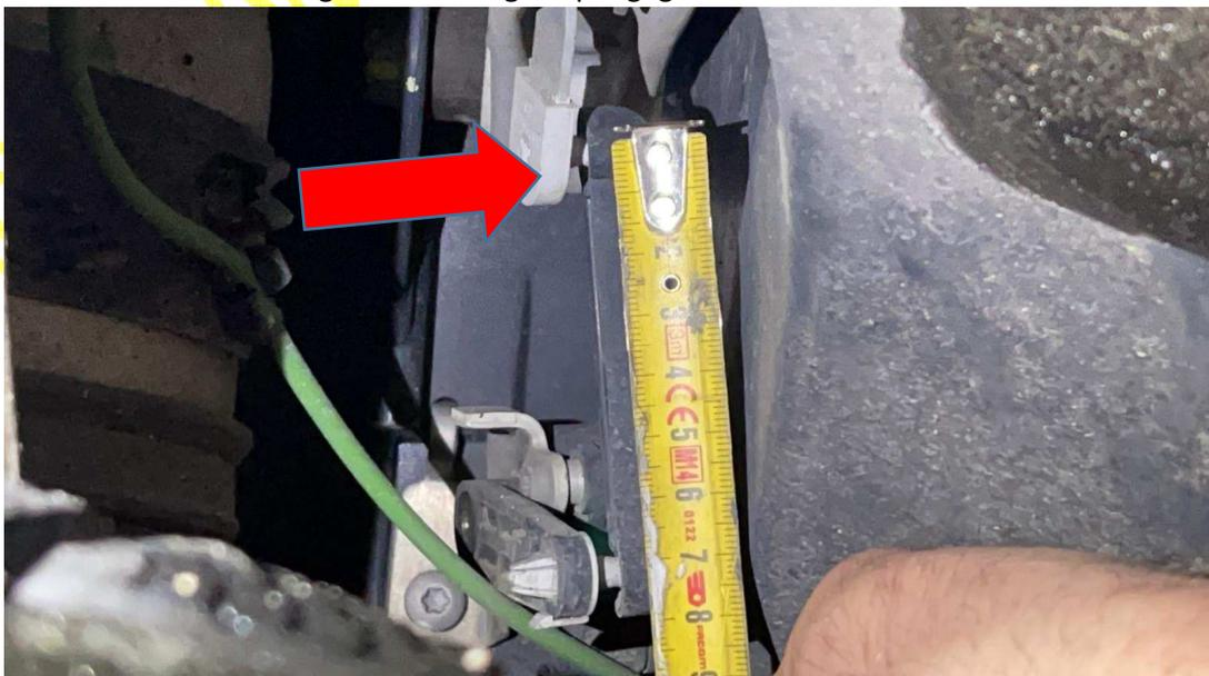
4. Montieren der neuen einstellbaren Koppelstangen. Diese werden aufgeclipst (viel leichter als die Originalen Koppelstangen). **Wichtig:** Anschließend werden die Sicherungsnasen (siehe Pfeile) oben und unten durch drücken eingerastet. Somit sind die Koppelstangen gesichert und können sich nicht lösen:
